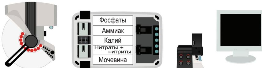
Возможно одновременное определение фосфора и азота, например, аммиачный азот после экстракции или как общий азот после минерализации по Кьельдалю и фосфор после экстракции по методикам Bray и Olsen или по другим методикам, или как общий фосфор после «мокрой» минерализации.
