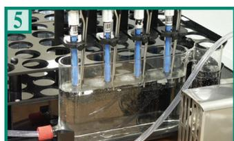
5 Зонды и мешалки промываются между каждыми действиями
