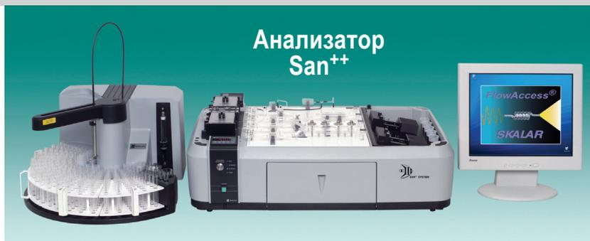
Анализатор имеет удобный модульный дизайн и может быть сконфигурирован в соответствии с потребностями любой лаборатории. Один или два химических канала могут обработать как небольшую рабочую загрузку, так и большую рабочую загрузку с числом образцов до 500/в день. Вплоть до 16 параметров можно анализировать одновременно, при необходимости можно вводить до 4 различных матриц образца за один раз.
